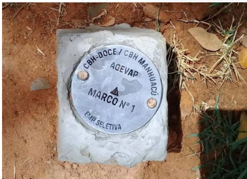
Figura 8 – Exemplo de marco topográfico
