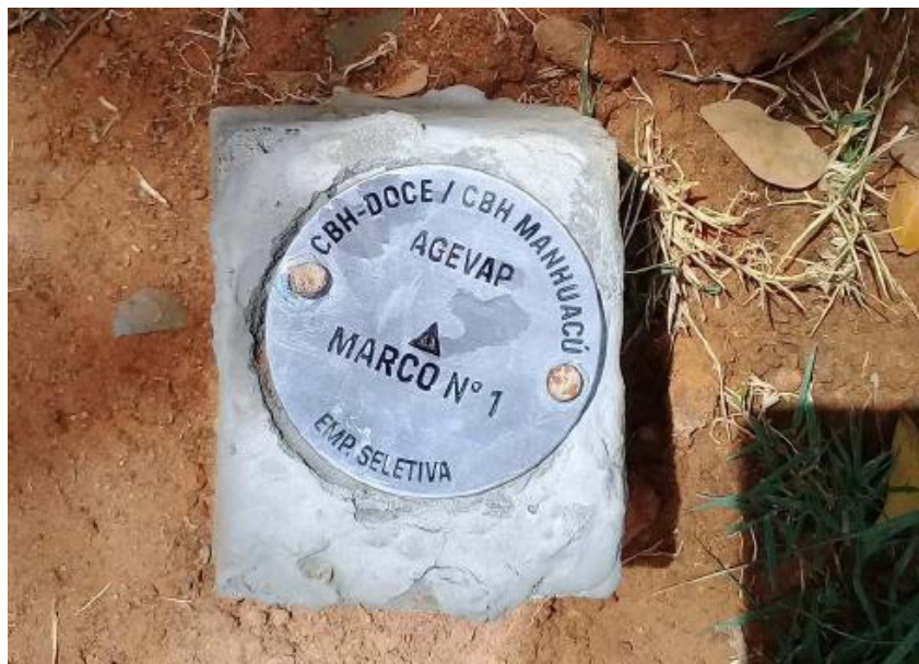
Figura 7 – Exemplo de marco topográfico
